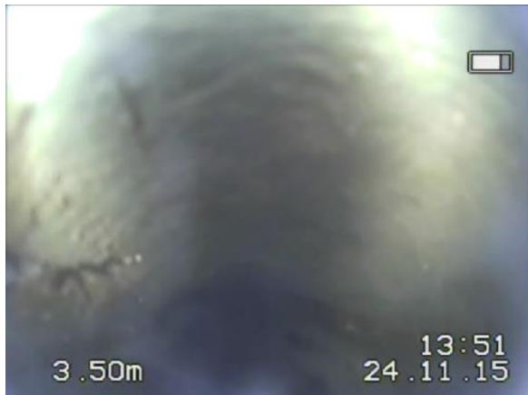
Rys.4.7. Skośne, krótkie spękania na głębokości otworu 3,5-3,75 m.
