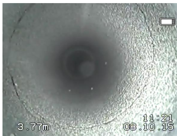
Rys. 4.10. Spękania skośne (20°) na głębokości otworu 3,8 m, o rozwarciu szczelin do 1 mm.
