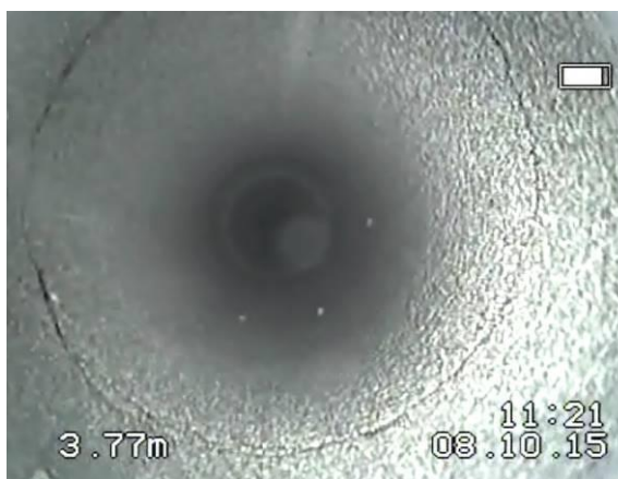
Rys. 4.2.9. Spękania skośne (20°) na głębokości otworu 3,8 m, o rozwarcu szczelin do 1 mm.
