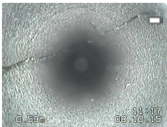
Rys. 4.2.4. Spękania skośne na głębokości otworu 0,1-0,7 m, o rozwierciu szczelin do 1mm.
