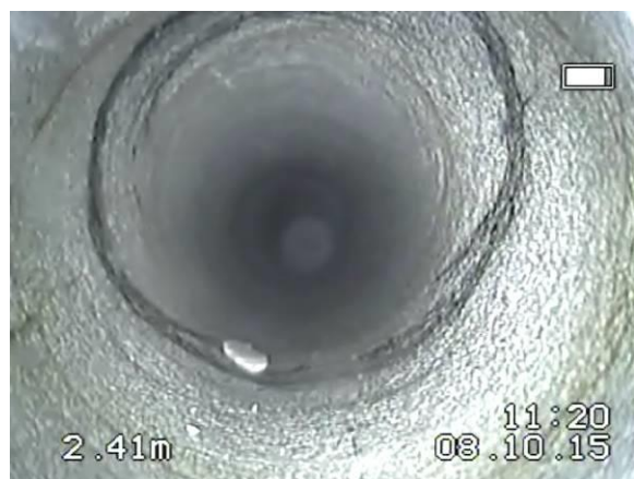
Rys. 4.2.8. Spękania skośnych na głębokości otworu 2,5 m, o rozwarcu do 1mm.
