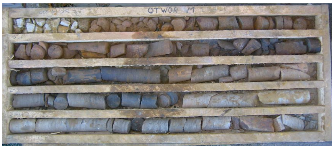
Rys. 4.3.1. Rdzeń otworu stropowego VI wykonanego w Chodniku "Dechen" 50 m na południe od Sztolni Południowej.
