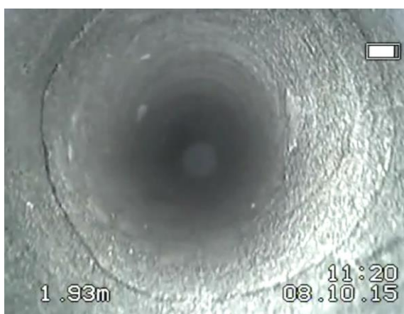
Rys. 4.14. Spękania skośne na głębokości otworu 2,0 m, o rozwarciu do 1mm..
