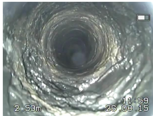
Rys.4.9. Strefa spękań skośnych o rozwarcu do 2 mm na głębokości otworu 2,5 m, szczeliny mokre.
