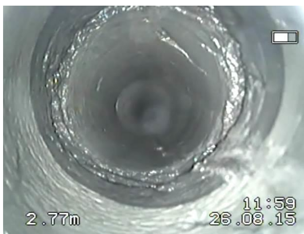
Rys.4.10. Strefa spękań skośnych o rozwarcu do 2 mm na głębokości otworu 2,8 m, szczeliny mokre.
