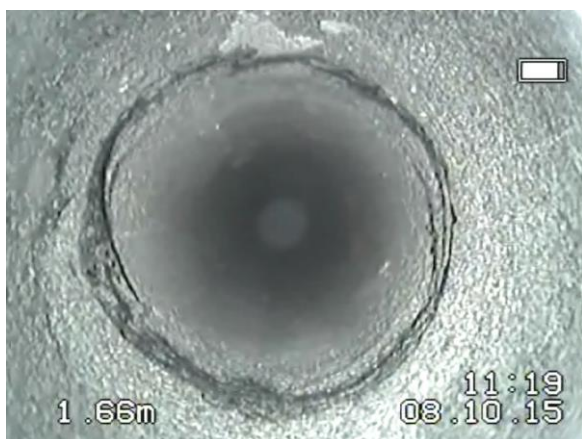
Rys. 4.2.5. Strefa spękań poziomych i skośnych na głębokości otworu 1,7 m, o rozwierciu do 1mm.
