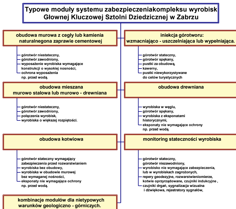
Rys. 5.1.2. Typowe moduły możliwe do zastosowania do docelowego zabezpieczenia Przecinki XI „Skalley” - na odcinku od punktu zlokalizowanego 10 metrów na północ od nitki północnej sztolni do skrzyżowania z nitką południową sztolni.
