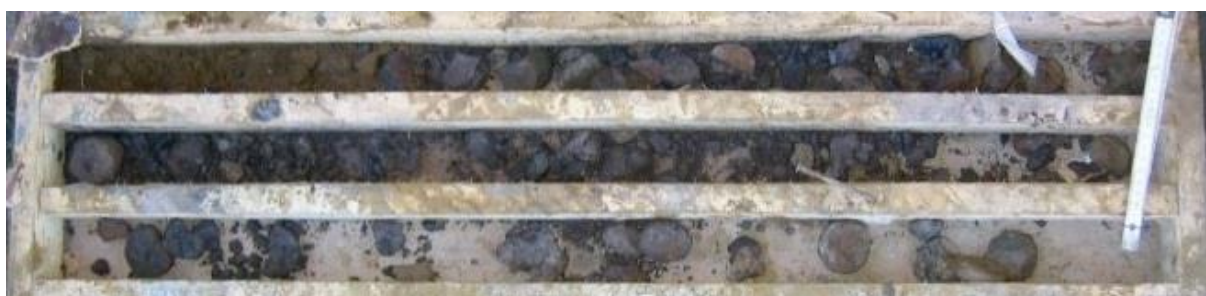
Rys. 4.3.2. Rdzeń otworu spągowego V2 wykonanego w Chodniku "Dechen" 50 m na południe od Sztolni Południowej.
