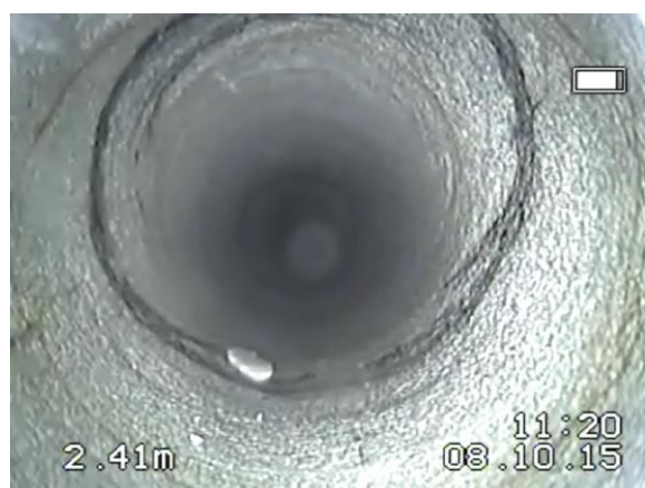
Rys. 4.15. Spękania skośnych na głębokości otworu 2,5 m, o rozwarciu do 1mm.
