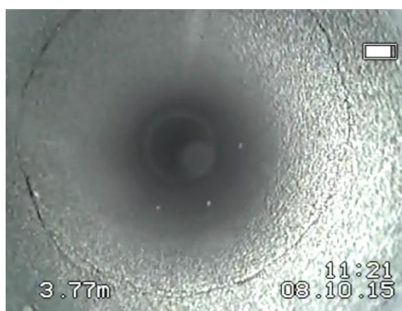
Rys. 4.2.8. Spękania skośne (20°) na głębokości otworu 3,8 m, o rozwierciu szczelin do 1 mm.
