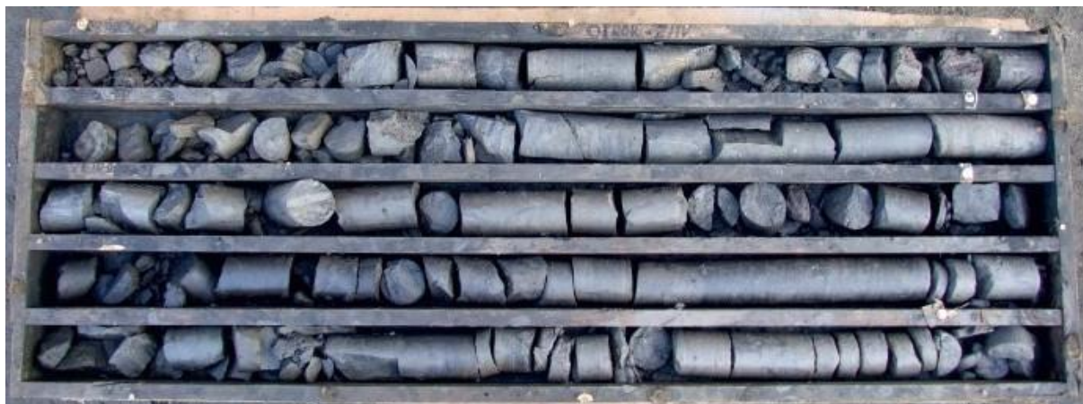
Rys. 4.3.4. Rdzeń otworu stropowego 2/IV wykonanego w nitce południowej.
