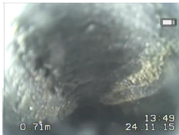
Rys.4.2.11. Pionowe spękanie o rozwierciu 1 mm.
