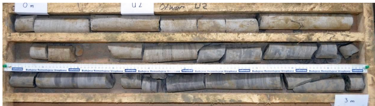
Rys. 4.114. Rdzeń otworu spągowego U2 wykonanego w rejonie połączenia chodnika "Dechen" ze Sztolnią południową.
