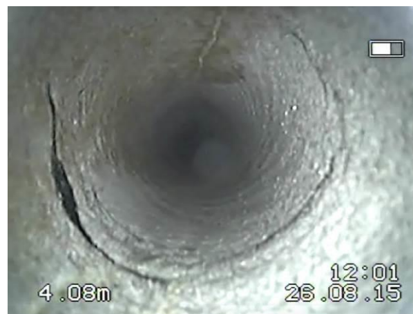
Rys.4.13. spękania poziome i skośne (80°) o rozwarcu do 1 mm na głębokości otworu 4,1m.
