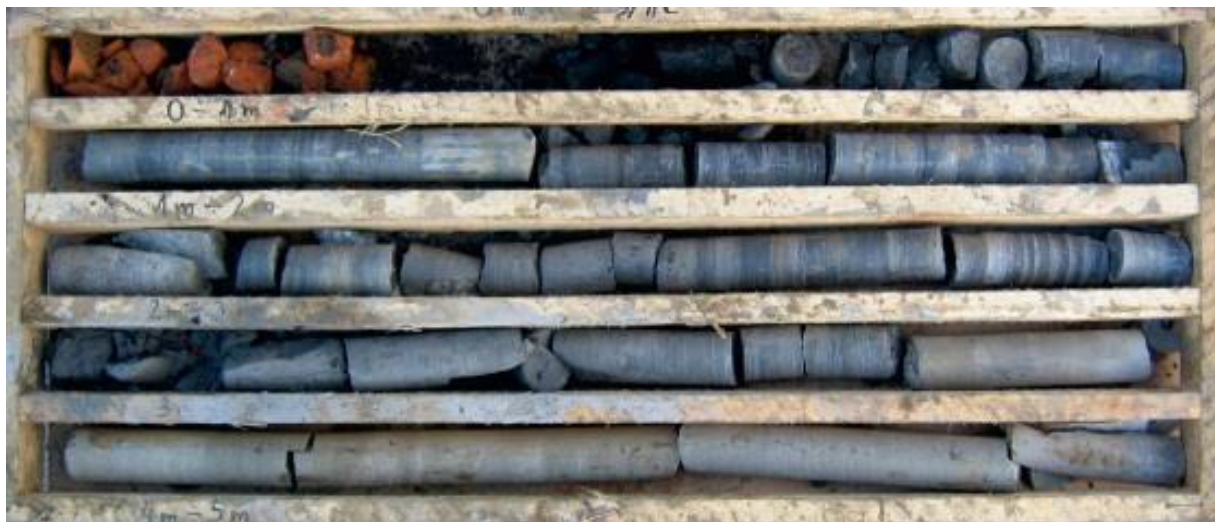
Rys. 4.3.2. Rdzeń otworu stropowego 3/IIc wykonanego w rejonie połączenia Sztolni Północnej z Przecinka nr 9 Luiza.
