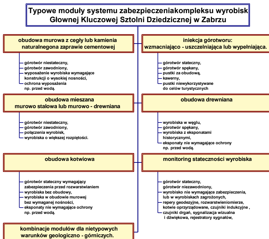
Rys. 5.1.2. Typowe moduły możliwe do zastosowania do docelowego zabezpieczenia chodnika „Dechen”
