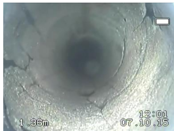
Rys.4.2.7. Strefa spękań poziomych i skośnych przecinających się na głębokości 1,25-1,55 m.
