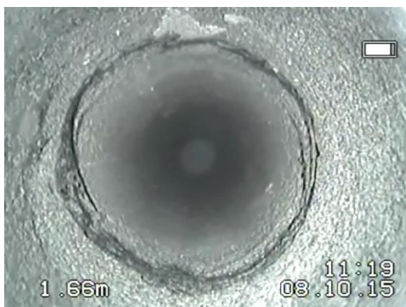
Rys. 4.7. Strefa spękań poziomych i skośnych na głębokości otworu 1,7 m, o rozwarciu do 1mm.
