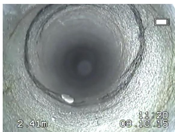
Rys. 4.2.7. Spękania skośnych na głębokości otworu 2,5 m, o rozwierciu do 1mm.
