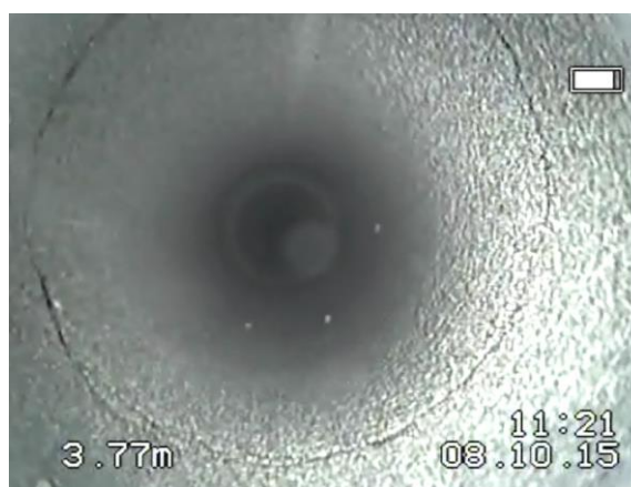
Rys. 4.16. Spękania skośne ( 20^\circ ) na głębokości otworu 3,8 m, o rozwarciu szczelin do 1 mm.
