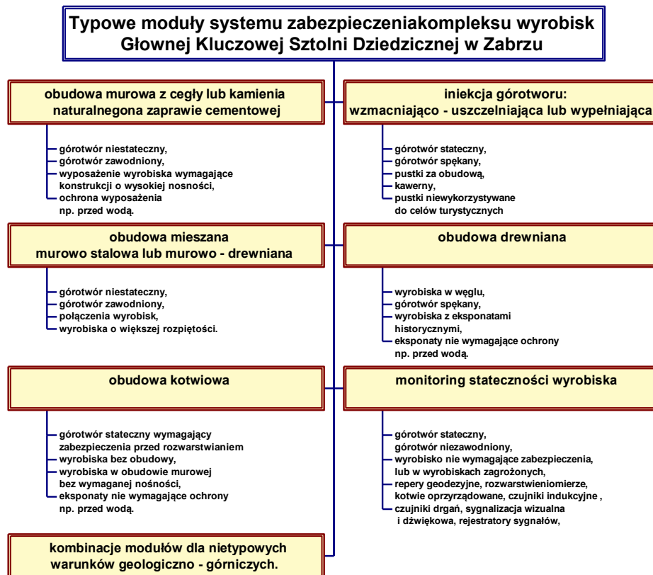
Rys. 5.1.2. Typowe moduły możliwe do zastosowania do docelowego zabezpieczenia przecinki VI „Heinitz spalony”
