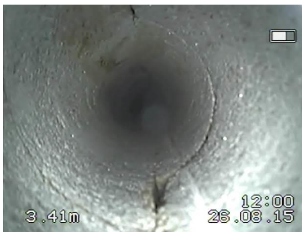
Rys.4.12. spękania pionowe i skośne (80°) o rozwarcu do 1 mm na głębokości otworu 3,4 m.
