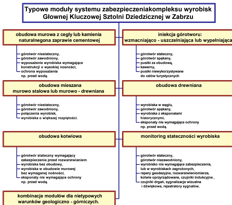
Rys. 5.1.2. Typowe moduły możliwe do zastosowania do docelowego zabezpieczenia przecinki IX „Luiza”
