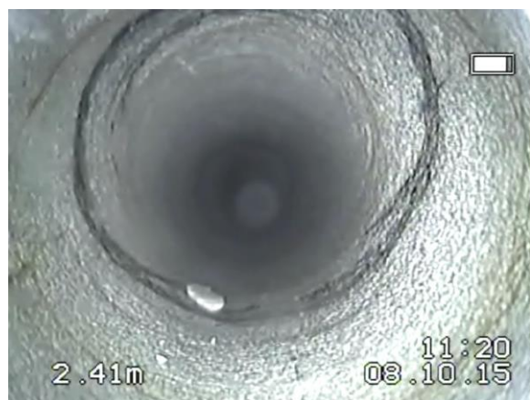
Rys. 4.9. Spękania skośnych na głębokości otworu 2,5 m, o rozwarciu do 1mm.
