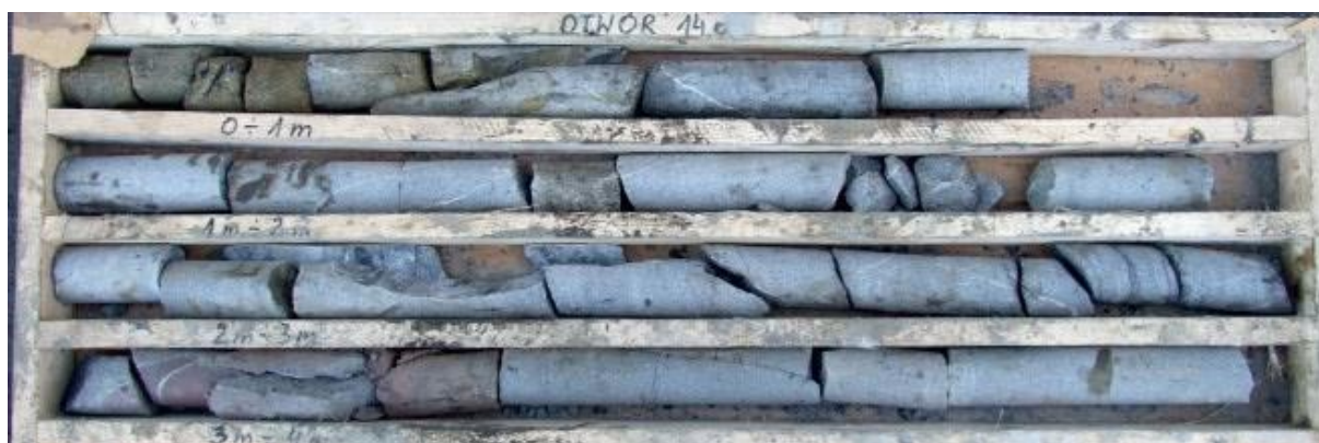
Rys. 4.3.3. Rdzeń otworu ociosowego 14a wykonanego w Sztolni południowej.
