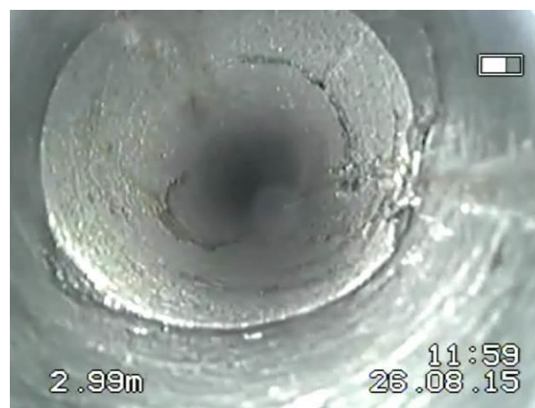
Rys.4.11. Spękania poziome i skośne (80°) o rozwarcu do 1 mm na głębokości otworu 3,0 m.
