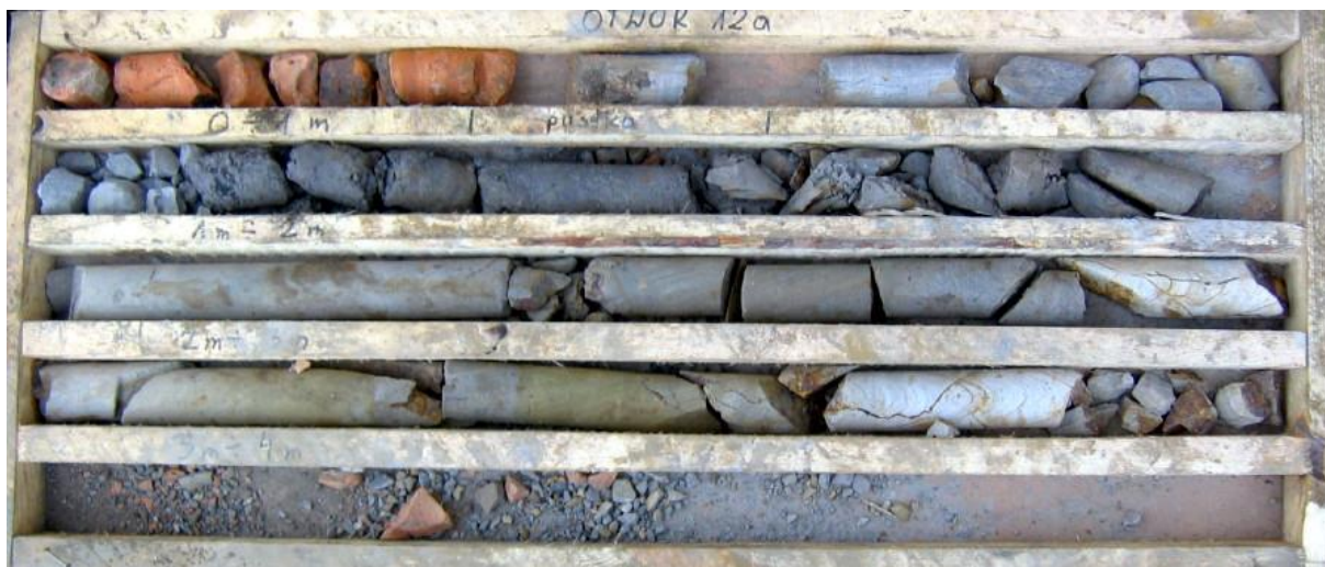
Rys.4.21. Rdzeń otworu ociosowego 12a wykonanego w Sztolni Północnej.
