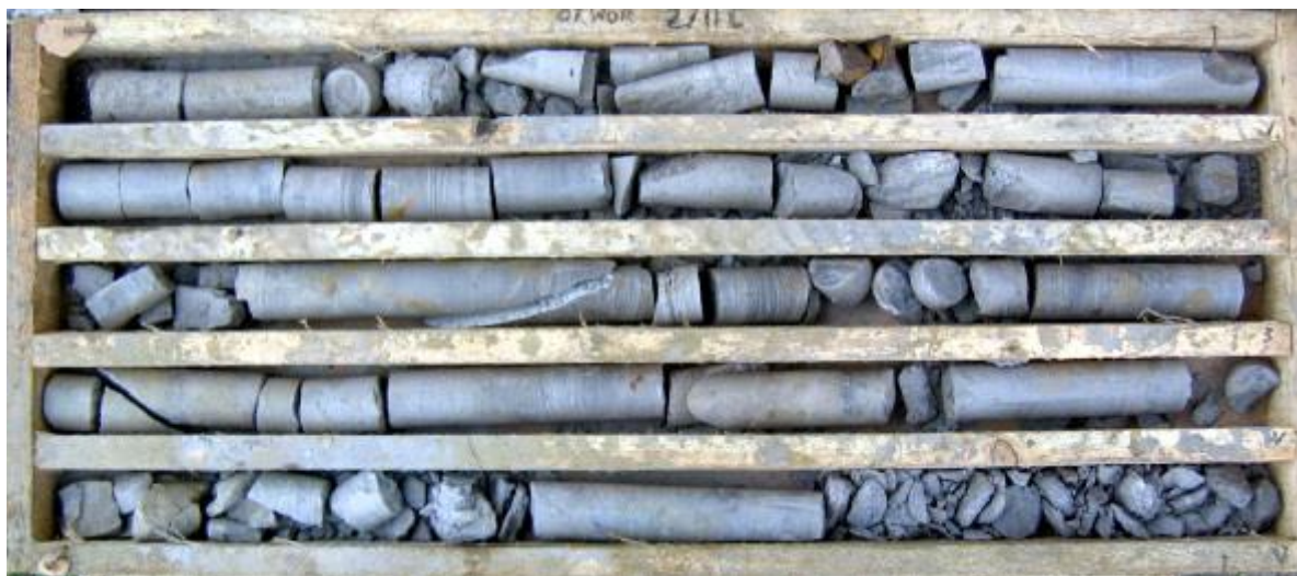
Rys.4.20. Rdzeń otworu stropowego 3/IV wykonanego w Sztolni Północnej.
