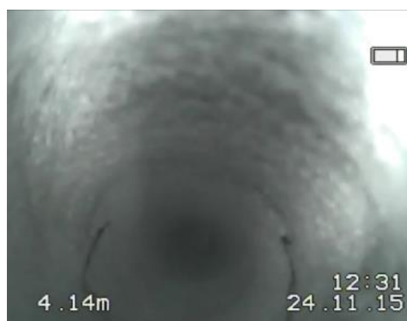
Rys.4.2.18. Spękanie poziome na głębokości otworu 4,15 m o rozwarciu 1 mm.
