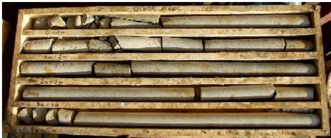
Rys. 4.3.2. Rdzeń otworu stropowego 1/IIc wykonanego w skrzyżowaniu Sztolni północnej z przecinką XI „Skalley”.
