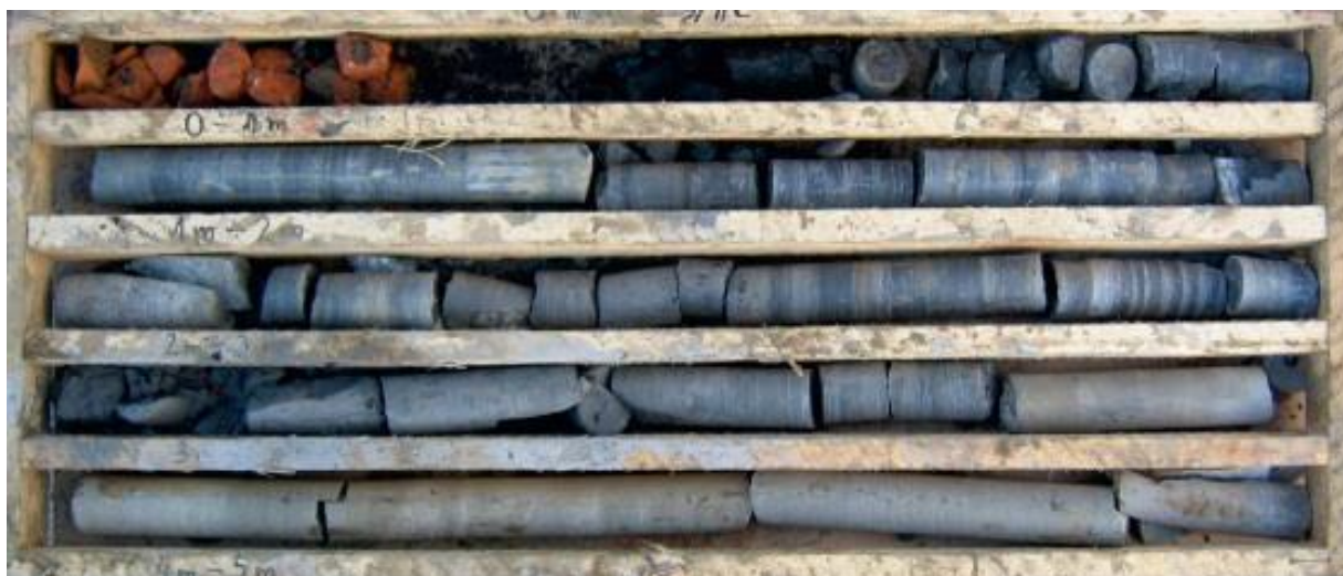
Rys. 4.10. Rdzeń otworu stropowego stropowego 3/IIC wykonanego w rejonie połączenia Sztolni Północnej ze Sztolnią Luiza.
