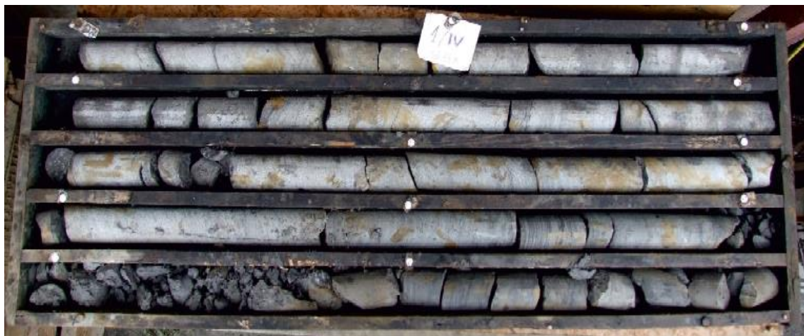
Rys. 4.3.3. Rdzeń otworu stropowego 1/IV wykonanego w nitce północnej GKSD
