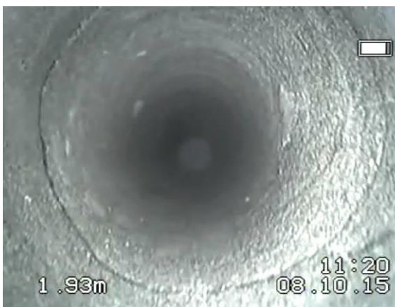
Rys. 4.2.7. Spękania skośne na głębokości otworu 2,0 m, o rozwarcu do 1mm..
