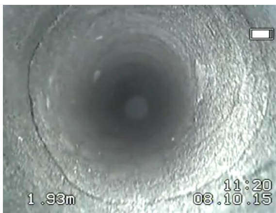
Rys. 4.2.6. Spękania skośne na głębokości otworu 2,0 m, o rozwierciu do 1mm..
