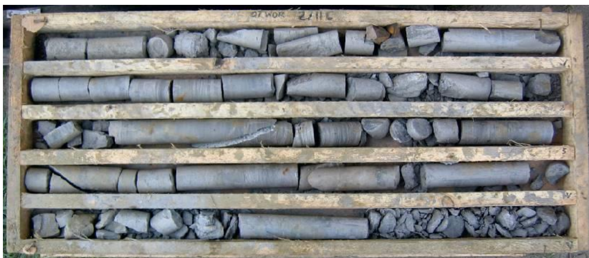
Rys. 4.19. Rdzeń otworu stropowego 2/IIC wykonanego w Sztolni południowej.
