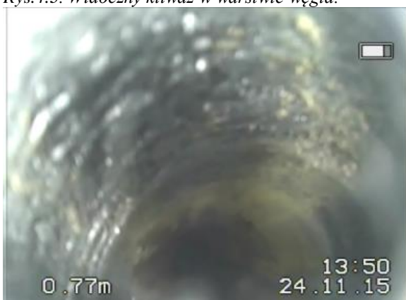
Rys.4.5. Drobne spękania poziome i prawie poziome o rozwierciu do 1 mm.
