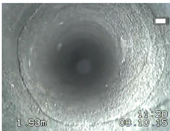
Rys. 4.8. Spękania skośne na głębokości otworu 2,0 m, o rozwarciu do 1mm..
