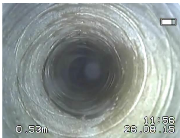
Rys.4.4. Spękania poziome i skośne o rozwarcu do 1 mm na głębokości otworu 0,5 m.
