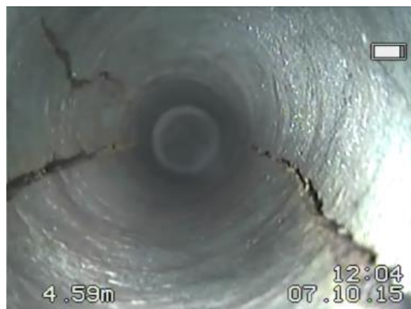
Rys. 4.2.11. Silne pionowe spękania o rozwarciu do 3 mm na głębokości 4,45-5,0 m.
