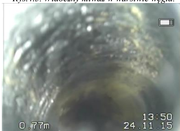
Rys.4.5 Drobne spękania poziome i prawie poziome o rozwarciu do 1 mm.
