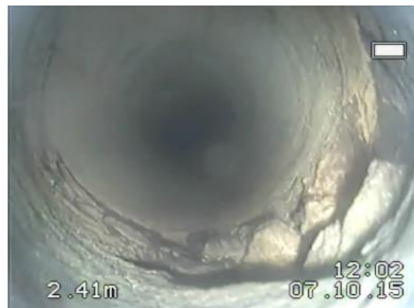
Rys.4.2.9. Poziome spękanie oraz ubytki skalne o rozwarciu do 20 mm na głębokości otworu 2,4 m.
