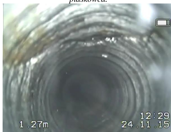
Rys.4.8. Spękanie skośne o rozwarciu 2 mm, nie obejmujące całego obwodu otworu.
