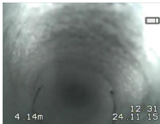
Rys.4.12. Spękanie poziome na głębokości otworu 4,15 m o rozwarciu 1 mm.
