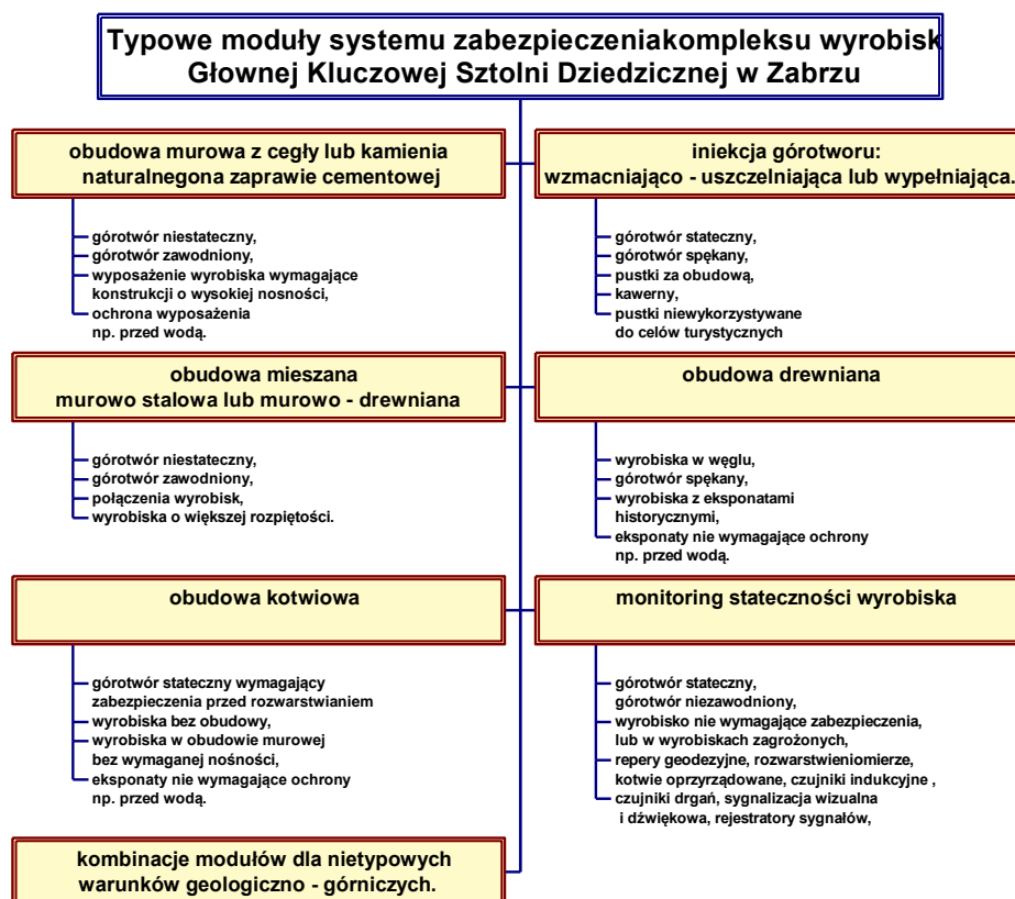
Rys. 5.1.2. Typowe moduły możliwe do zastosowania do docelowego zabezpieczenia pompowni P2 i urządzeń podczyszczania wód
