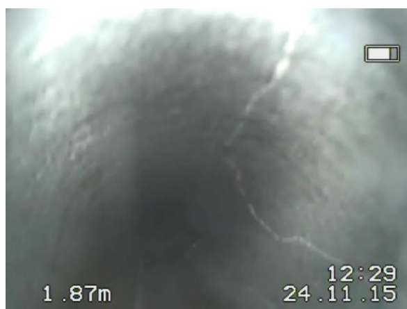
Rys.4.9. Schodzące się spękania skośne na głębokości otworu 1,7-2,0 m o rozwarciu 1 mm
