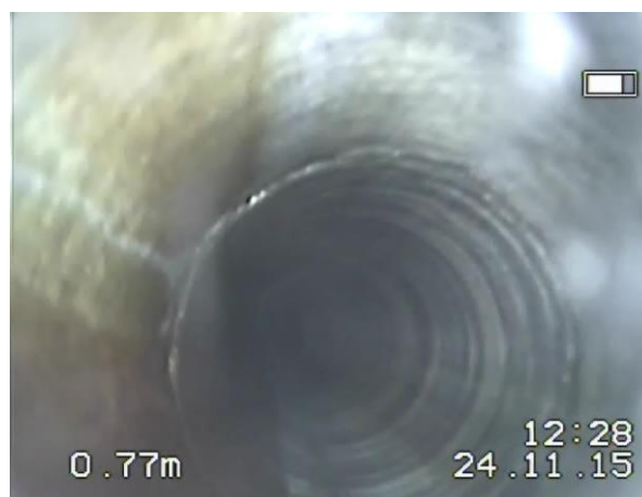
Rys.4.6. Spękanie poziome o rozwarciu 1 mm występujące w strefie falistej laminacji piaskowca.
