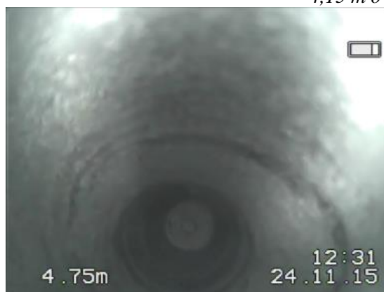
Rys.4.13. Spękania skośne o rozwarciu do 1 mm na głębokości otworu 4,75-4,9 m.
