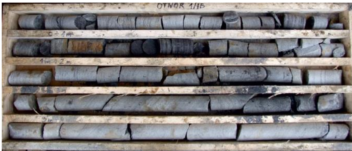
Rys. 4.14. Rdzeń otworu stropowego 1/IB wykonanego w rejonie Rozwidlenia zachodniego.
