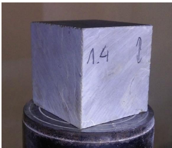
Rys. 5.46. Próbką 1.4 przed badaniem wytrzymałościowym.
