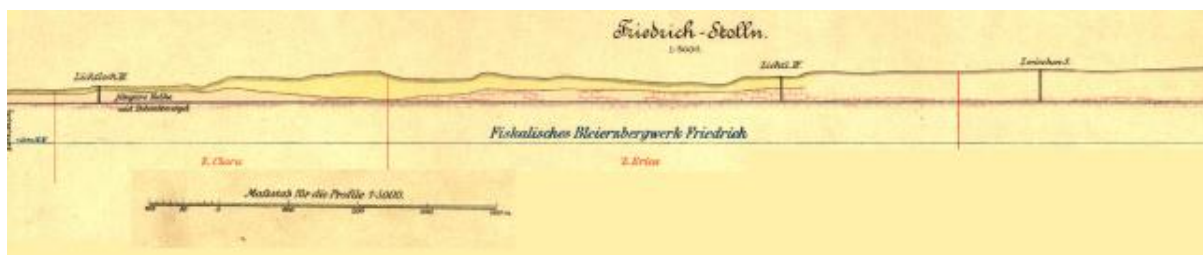
Rys.3.4. Przekrój geologiczny wzdłuż sztolni „Fryderyk” część wschodnia na podstawie „Karte des Oberschlesischen Erzbergbaues”.
