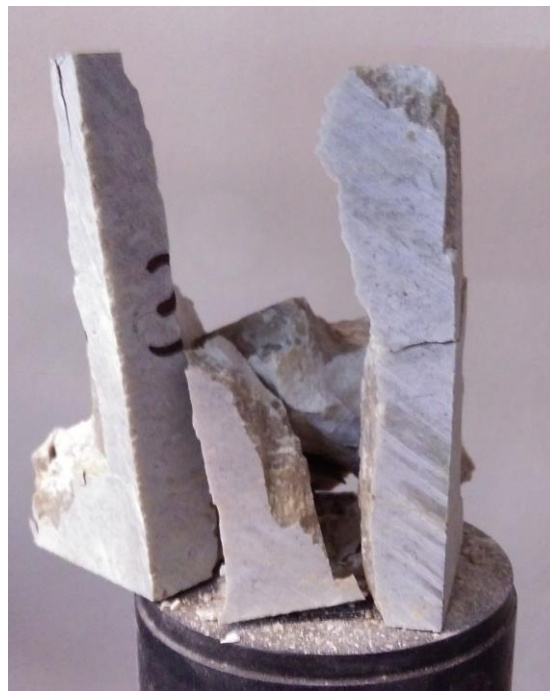
Rys. 5.49. Próbką 3.2 zniszczona po badaniu wytrzymałościowym.
