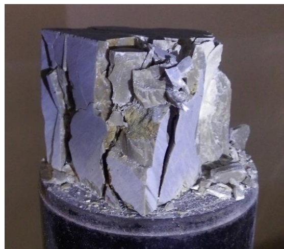
Rys. 5.47. Próbką 1.4 zniszczona po badaniu wytrzymałościowym.
