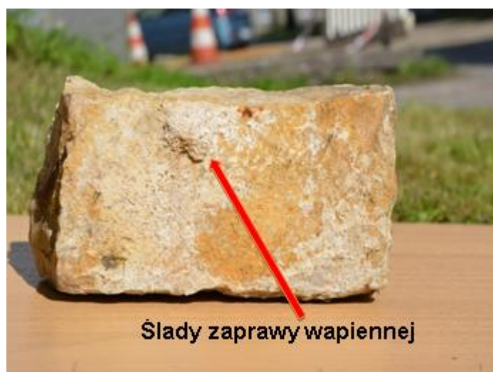
Rys.5.41. Ślady zaprawy wapiennej na próbce.
