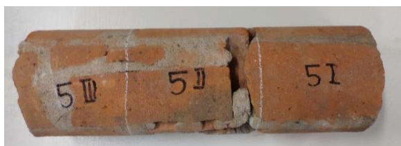
Rysunek 11 Pobrane rdzenie z oznaczeniem próbek do badań wytrzymałościowych
