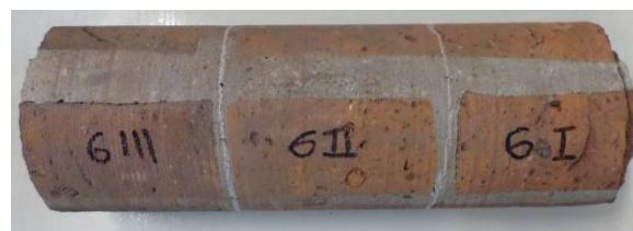
Rysunek 11 Pobrane rdzenie z oznaczeniem próbek do badań wytrzymałościowych
