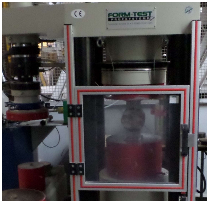
Rysunek 12 Po lewej – sposób ściskania próbki pobranej z konstrukcji, po prawej – widok badań niszczących.
