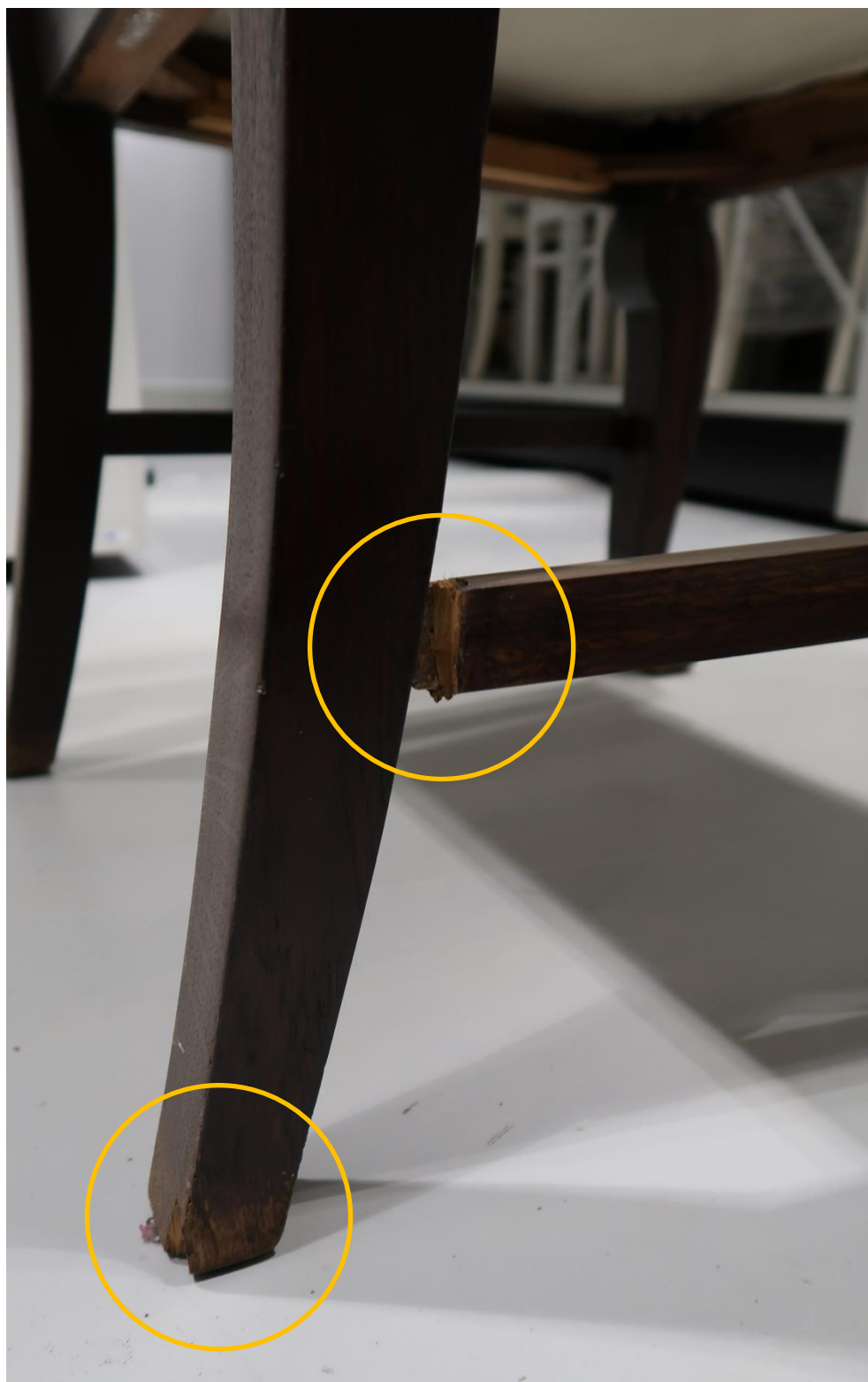
Konstrukcyjne uszkodzenie krzesła z widocznym na dole uszczerbkiem nogi.
