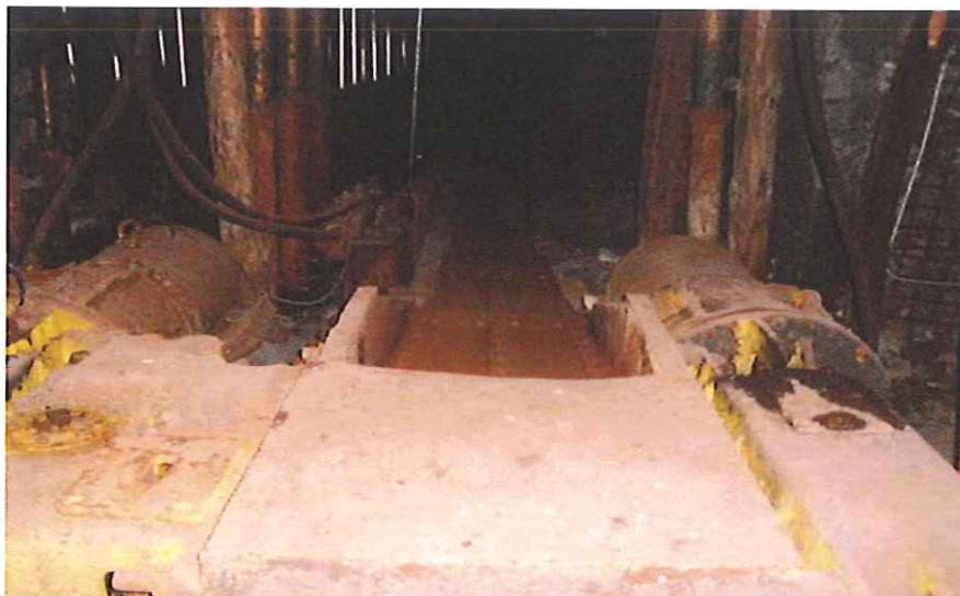
Górny napęd przenośnika ścianowego R-73
